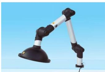
Terfu modello ESP con giunti in polipropilene conduttivo e tubazioni in alluminio anodizzato, i braccetti sono completamente conduttori elettrici e tutta l'elettricità statica eventualmente presente viene scaricata con uno speciale attacco di collegamento a terra.
