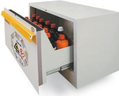
Costruzione in lamiera di acciaio elettrozincata con spessori di 1; 1,5; 2 mm pressopiegata a freddo con struttura esterna smontabile verniciata con polveri epossidiche antiacido e passaggio in galleria termica a 200 °C.
