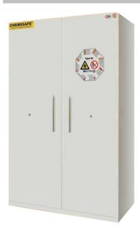
Costruiti completamente in lamiera di acciaio con spessori 1 - 1,5 mm, pressopiegata a freddo, verniciata con polveri epossidiche antiacido e passaggio in galleria termica a 200 °C.
