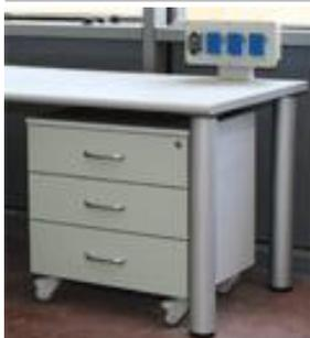
Armadietti sotto strutturali realizzati con pannelli in fibra di legno classe E1 idrofugo o classe E1 ignifugo secondo le norme DIN 4102 B1, rivestiti in melamina colore ARGENTO VIVO secondo le norme DIN 67 781 spessore complessivo del pannello 18 mm, bordature in melamina colore ARGENTO VIVO spessore 0,50 mm.
