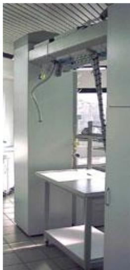
Realizzato con struttura interna in acciaio tubolare sezione mm. 30x30 trattata con verniciatura epossidica spessore 80 micron colore SILVER GOFFRATO RAL 9006, e tamponamenti esterni in nobilitato spessore 18 mm colore ARGENTO VIVO bordato in abs colore grigio arrotondato.
