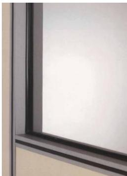
Composte da due lastre in cristallo di sicurezza accoppiato spessore mm. 3+3 oppure in alternativa in cristallo di sicurezza temperato spessore mm. 4, montate su di appositi profili in alluminio ossidato satinato naturale oppure colorato in esecuzione speciale.
