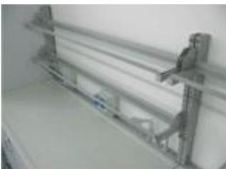
Le mensole portareagenti sono del tipo modulare ed indipendenti per ogni fronte di lavoro (nel caso dei banchi centrali), sono costituite da due bracci in tubolare sezione 30x30 spessore 1.5 mm collegati orizzontalmente da traversi di notevole spessore provvisti di dispositivo anticaduta frontale e posteriore.
