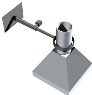
Le cappe per assorbimento atomico, sono realizzate in lamiera d'acciaio inox AISI 304 , satinata ; spessore 15/10, con tronchetto di raccordo per attacco tubazione d'aspirazione.
